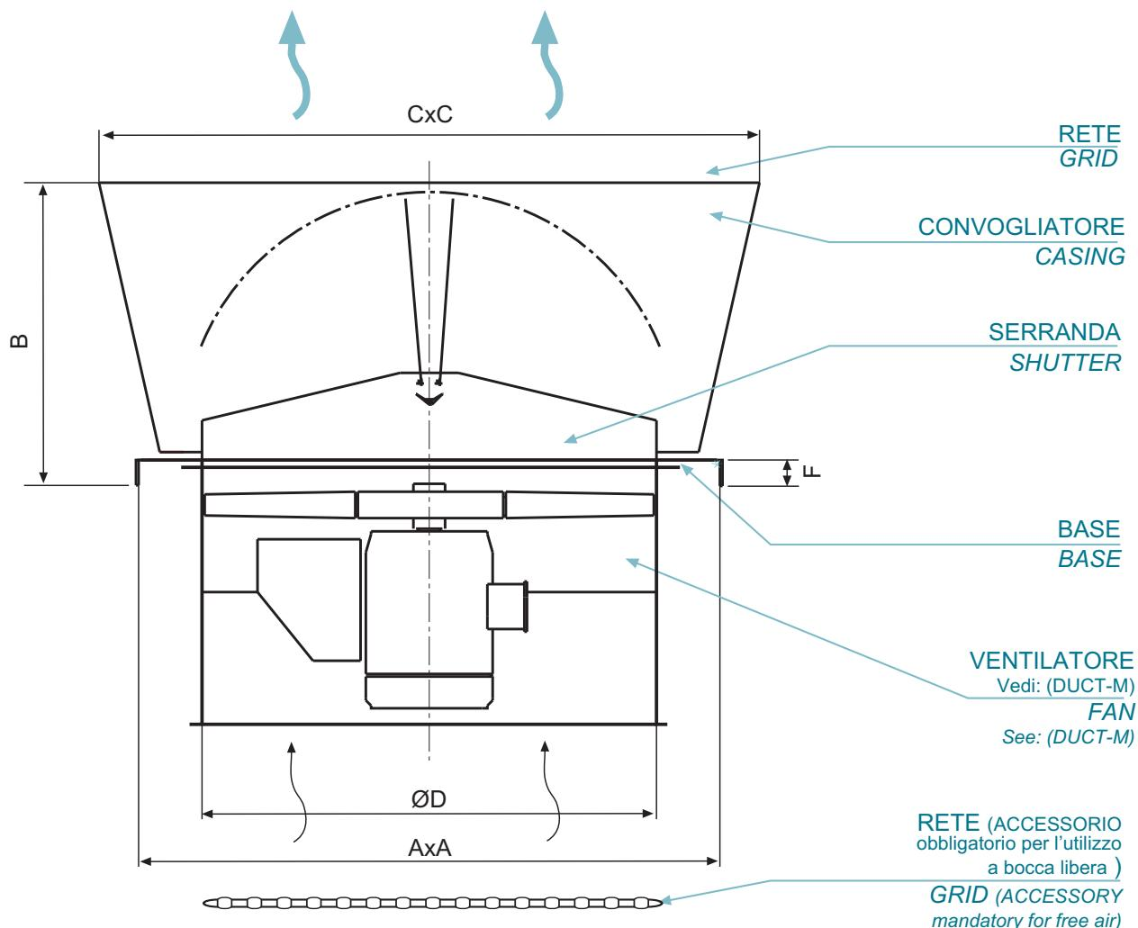
Fare riferimento alle prestazioni dei ventilatori DUCT 800-1250 versioni 4 e 6 poli. Sottrarre la perdita di carico della serranda pari a circa la metà della pressione dinamica del ventilatore corrispondente.
